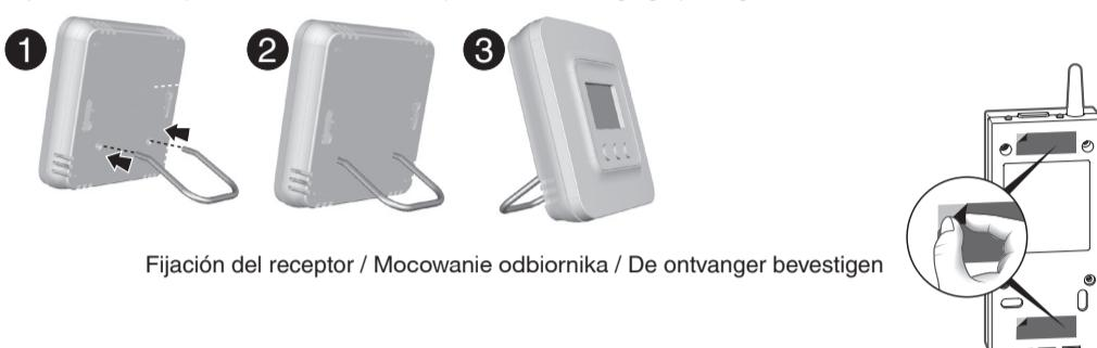
Fijación del receptor / Mocowanie odbiornika / De ontvanger bevestigen
